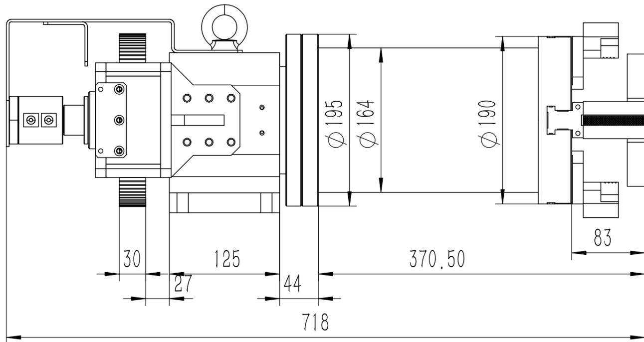
齿顶圆直径  $\phi 196$  Z96 M2
