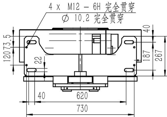
小齿轮Z30M5 β 9右旋 适配140法兰减速机
